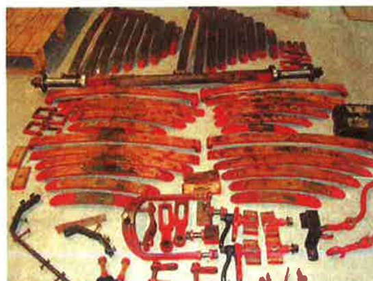
Teile der zerlegten Vorderachse mit Blattfedern
